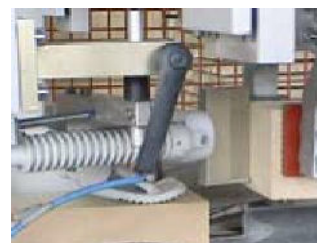
LK-100 Limpistol Pneumatisk, til ekstern styring Art. Nr. LT 512210
